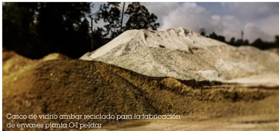
Casco de vidrio ambar reciclado para la fabricación de envases planta O-I peldar
